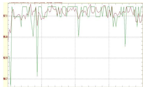
Рис. 10. Результат наложения данных модели на исторические лабораторные данные из архива трендов датчика позиции Q, качества отбора изомеризата
