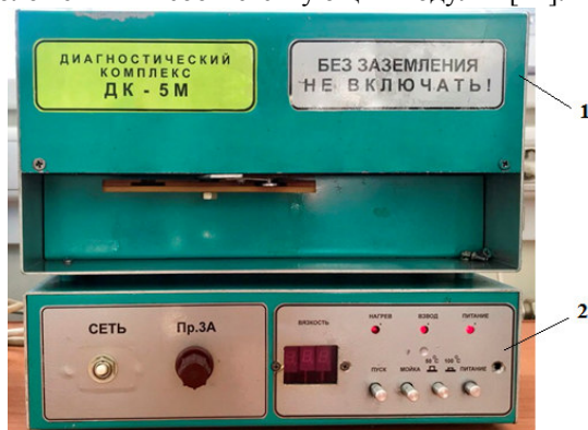
1 – механический блок; 2 – электронный блок
