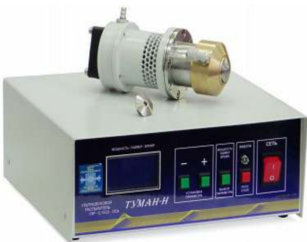
Рис. 11. Фото распылителя с системой формирования воздушных потоков
