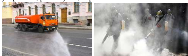
а) б) а – гидравлический способ при помощи «поливальных машин»; б – пневматический при помощи ручных распылителей.
