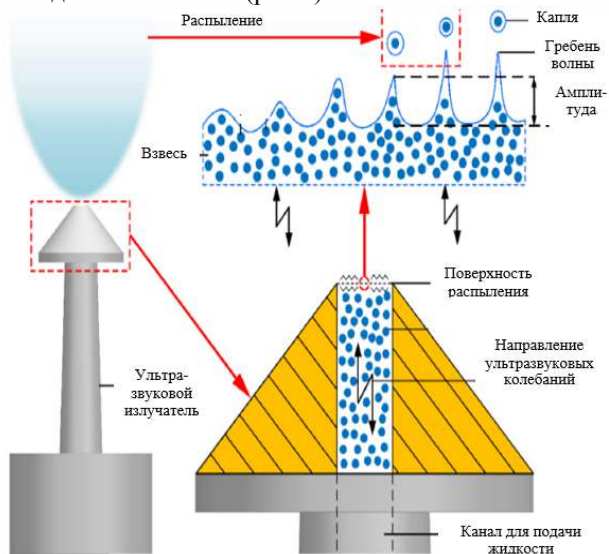
Рис. 3. Схематическое изображение процесса ультразвукового распыления жидкостей
