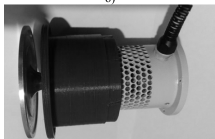
(а) – эскиз; (б) – форма колебаний дискового излучателя; (в) – фото излучателя; 1 – дисковый излучатель; 2 – пьезоэлектрический преобразователь; 3 – корпус; 4 – фланец; 5 – вентилятор
