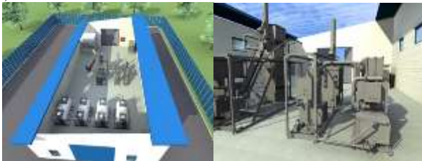
Рис. 7. Трёхмерная модель системы улавливания и хранения оксидов серы
