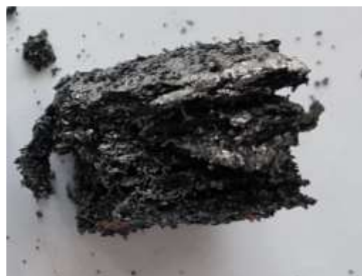
Рис. 3 Образец листового ТРГ (вид сбоку) после анализа термостойкости
