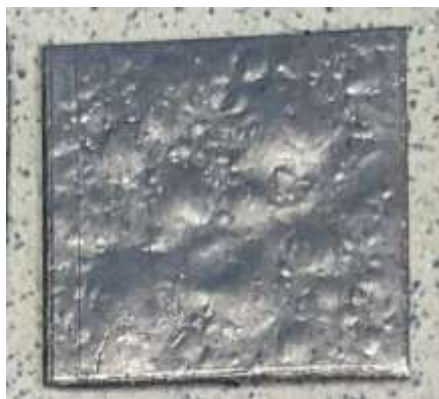
Рис. 5 Образец листового ТРГ после анализа термостойкости
