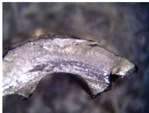
Рис. 8. Поперечный срез изоляции кабеля с восстановленным повреждением, в течение времени 0,9 сек вид сверху (фото сверху), вид сбоку (фото снизу)
