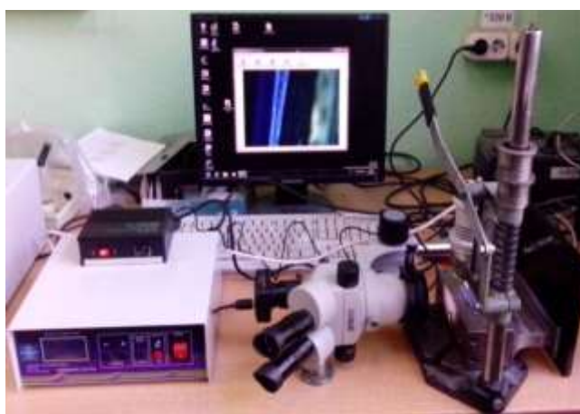
1 – ПК; 2 – УЗ аппарат; 3 – колебательная система со сварочным инструментом; 4 – микроскоп; 5 – камера для фотосъемки; 6 – опора;
