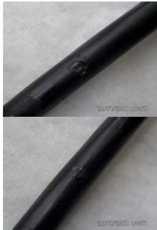
Рис. 5. Изоляция кабеля со сформированным швом за время 0,9 сек (сверху), за время 1,2 сек (снизу)
