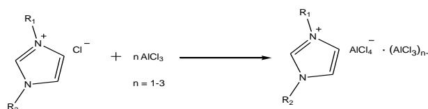
Рис.1 Взаимодействие хлористого алюминия с диалкилимидазолий хлоридом
