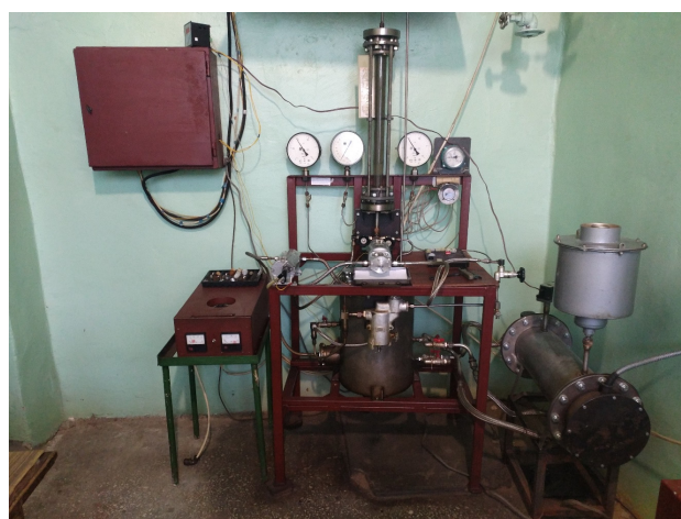
Рис. 2 Стенд для испытаний электронасосного агрегата
