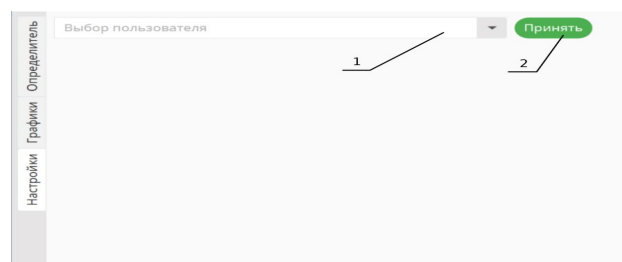
1 – комбинированный список; 2 – кнопка подтверждения выбора Рис. 7. Вкладка « Настройки »
