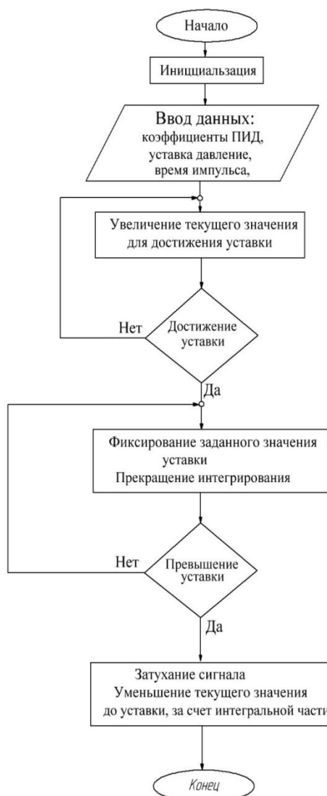
Рис.6. Блок-схема алгоритма работы программы ПИД-регулятор
