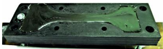
Рис. 2 Форма для отливки вместе с образцом из композиционного материала
