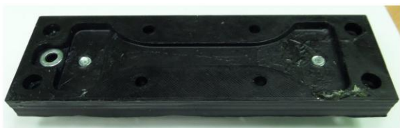
Рис. 1 Форма для отливки композиционного материала
