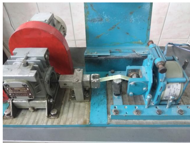
Рис. 2. Установка для испытаний на продольный изгиб Типичные кривые нагружения образцов в координатах деформация – напряжение приведены на рисун-
