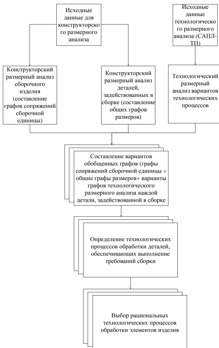
Рис. 2. Структура комплекса проектных процедур
