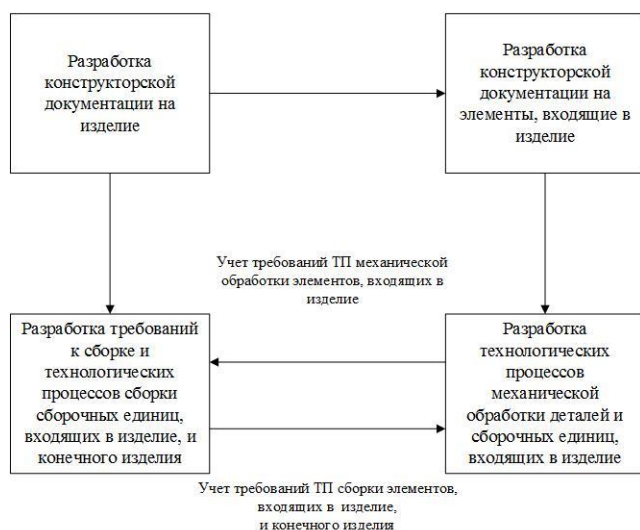
Рис. 1. Связь между технологической подготовкой обрабатываемого и сборочного производств с учетом требований, заложенных при проектировании изделия
