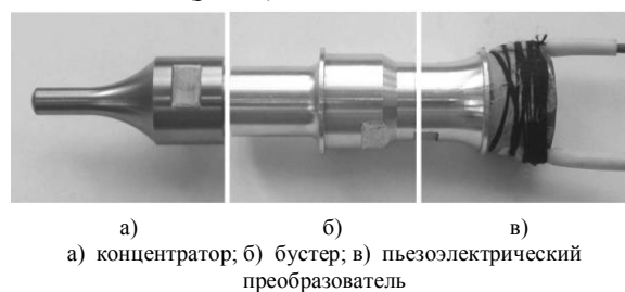
Рис. 3. Первый вариант ультразвуковой колебательной системы (УЗКС №1)
