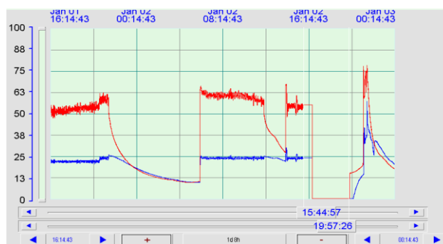
Рис. 4. Тренды изменения температуры воды и воздуха ПВУ здания во время аварийной ситуации
