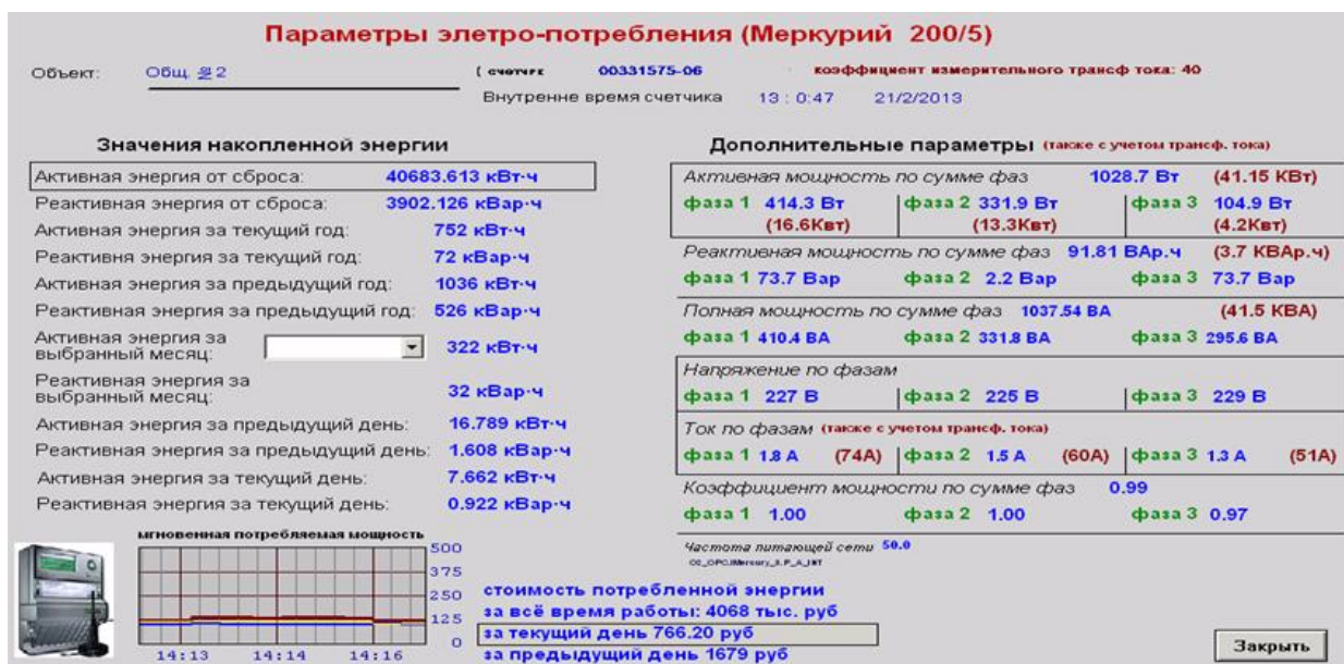
Рис. 5. Параметры системы электроснабжения здания
